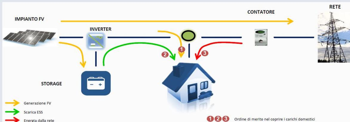
*In condizioni di particolare consumo dell'utenza, si possono creare le condizioni per l'erogazione di energia simultanea da fotovoltaico + batteria (+ rete).*
