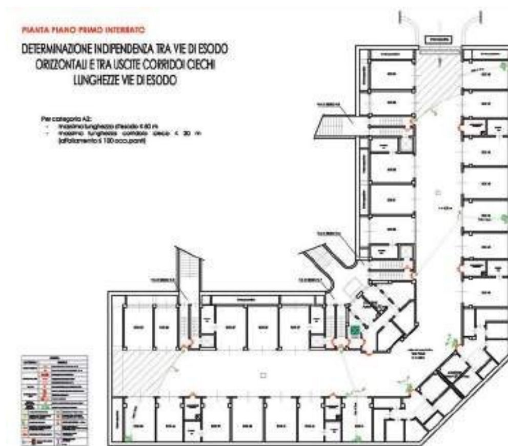
VIE D'ESODO DEL PIANO PRIMO INTERRATO
